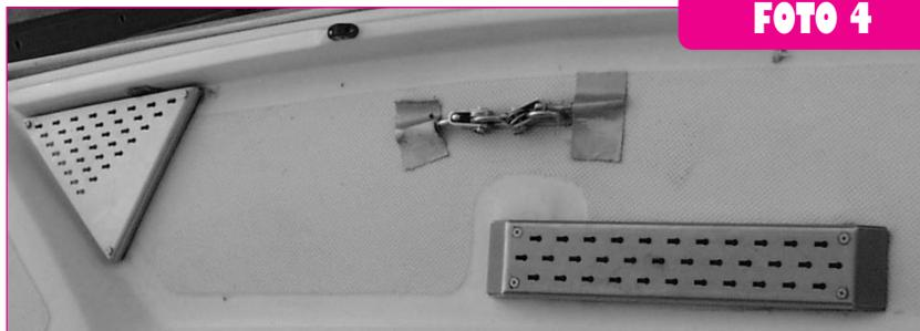
› Sulla piastrina di acciaio, montata sul carrello identico a quelli visti in precedenza mentre uno strozzatore Cam Matic 150 (T) sostituisce bozzello e strozzatore.
